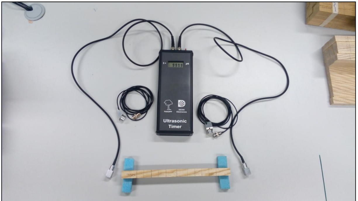
Obrázek 5: Fakopp UltraSonic Timer před měřením (David Novák)
