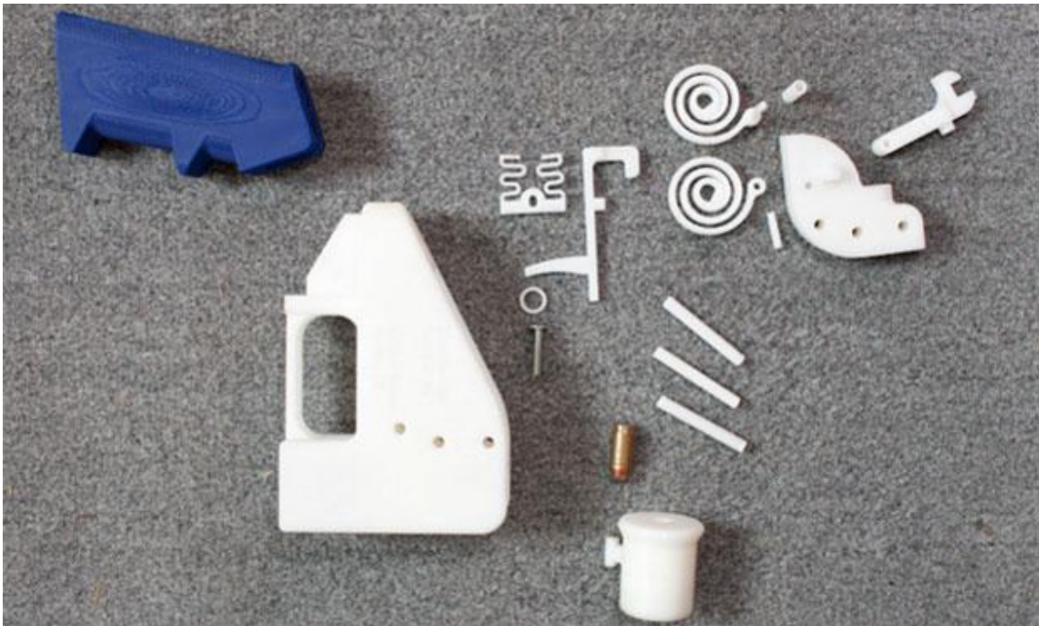
Obr. 22: Rozložená palná zbraň vytvorená aditívnym modelovaním (Zdroj 3)
