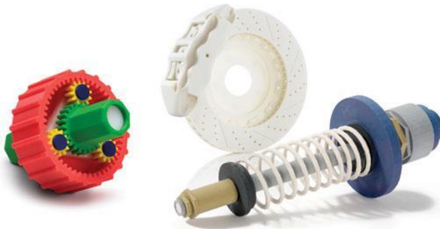
Obr. 3: Časti vytvorené pomocou FDM (Zdroj 9)
