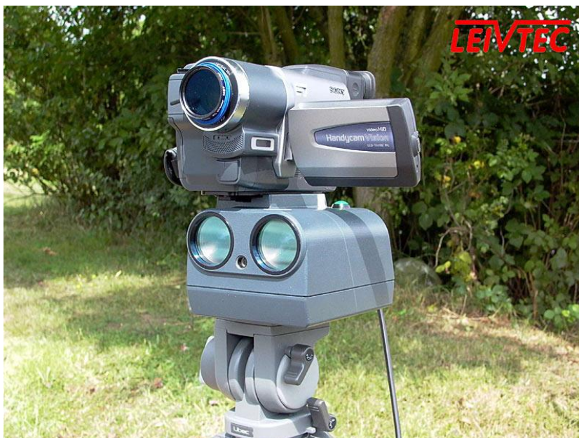
Obrázek 24 - Měřič rychlosti pracující na principu širokoúhlého infračerveného paprsku
