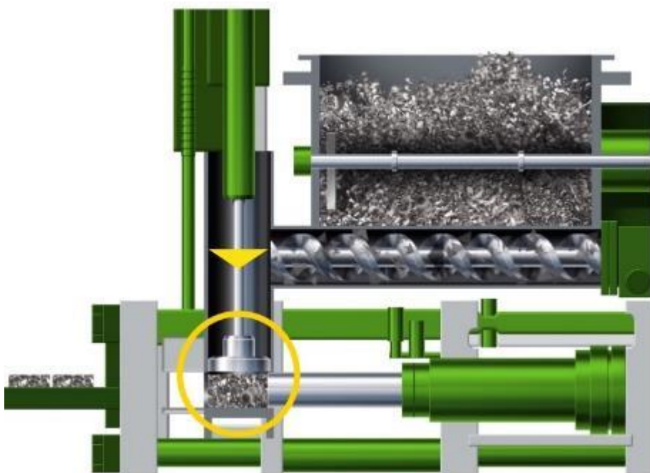
obr. 2-17 Lis firmy RUF – pohyb předlisování (upraveno) [29]
