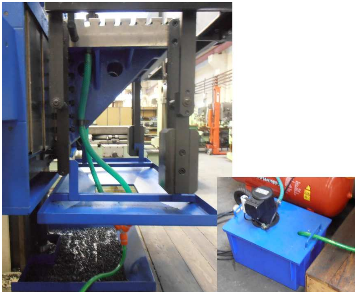
Obr. 15. Zapojení pryžových hadic odvádějících PK do nádoby externího chlazení (vlevo) a nádoba externího chlazení s čerpadlem (vpravo)
