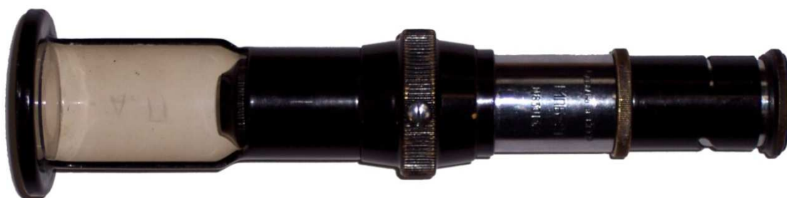
Obr. 22 Nástrojová lupa Brinell typ MPB-2 (zvětšení 24x) se stupnicí 0.05 mm
