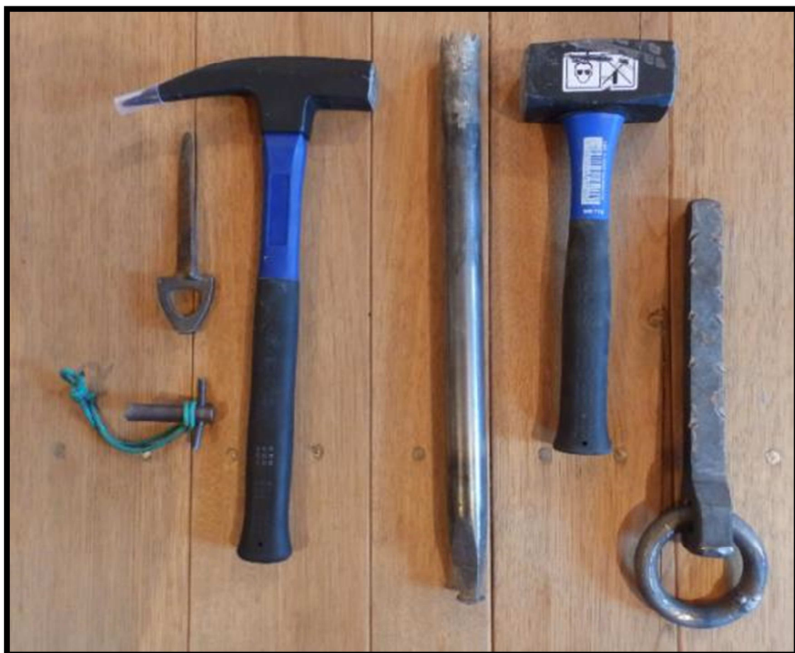
Obr. 11 – Nářadí - zleva navrtávák a skoba používané při odsednutí před osazením kruhu, kladivo k zatlučení navrtáváku či skoby, rourák k vytlučení díry pro kruh, palice na zatlučení kruhu a kruh postupového jištění.
