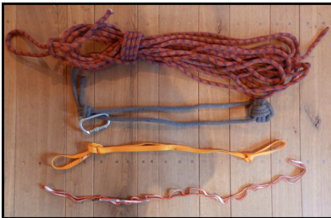
Obr. 13 – Vybava. Shora: Horolezecké lano, smyčka s velkým uzlem zvaná „kinderkopf“ a smyčka plochá s připravenými uzly, obě určené k postupovému jištění na tření ve spárách, odsedávací smyčka zvaná „daisychain“. Uprostřed je i karabina postupového jištění (fotografie z archivu autorky)
