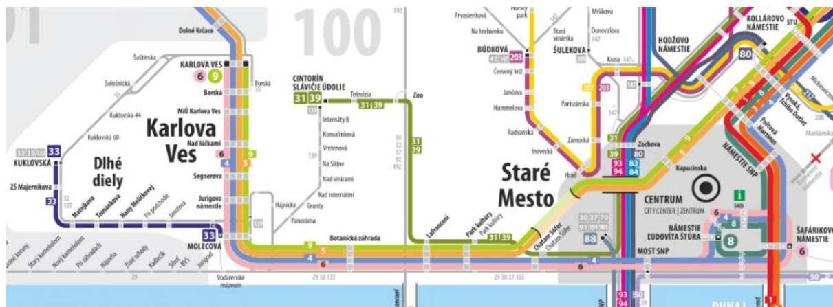
Obr. 4.2 Příklad mapy s více úrovněmi schematizace. Oblast Centrum zachovává menší generalizaci linií, vzdálenosti mezi zastávkami zachovávají měřítko. Oblasti mimo centrum zcela ruší měřítko, znaky zastávek jsou vzdáleny rovnoměrně, linie jsou schematizované (zdroj: http://imhd.sk ).
