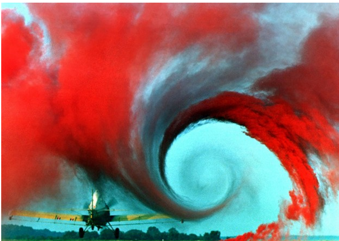
Obr.1: Turbulence v úplavu za letounem. Experiment provedla NASA
