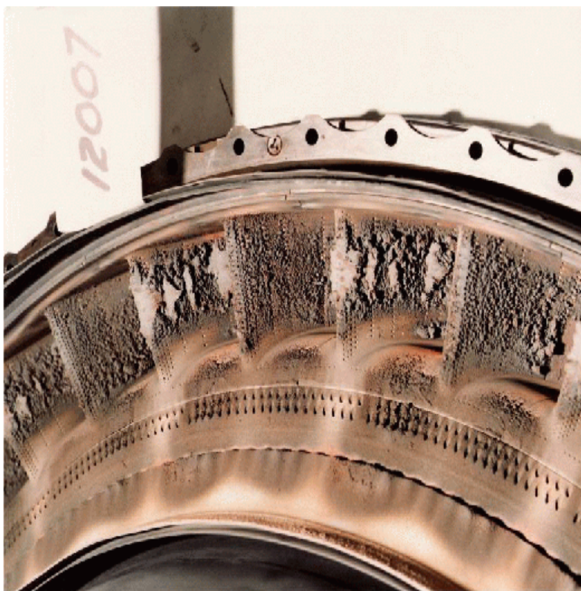
Obr. 14: Statorové lopatky proudového motoru po průletu sopečným mrakem
