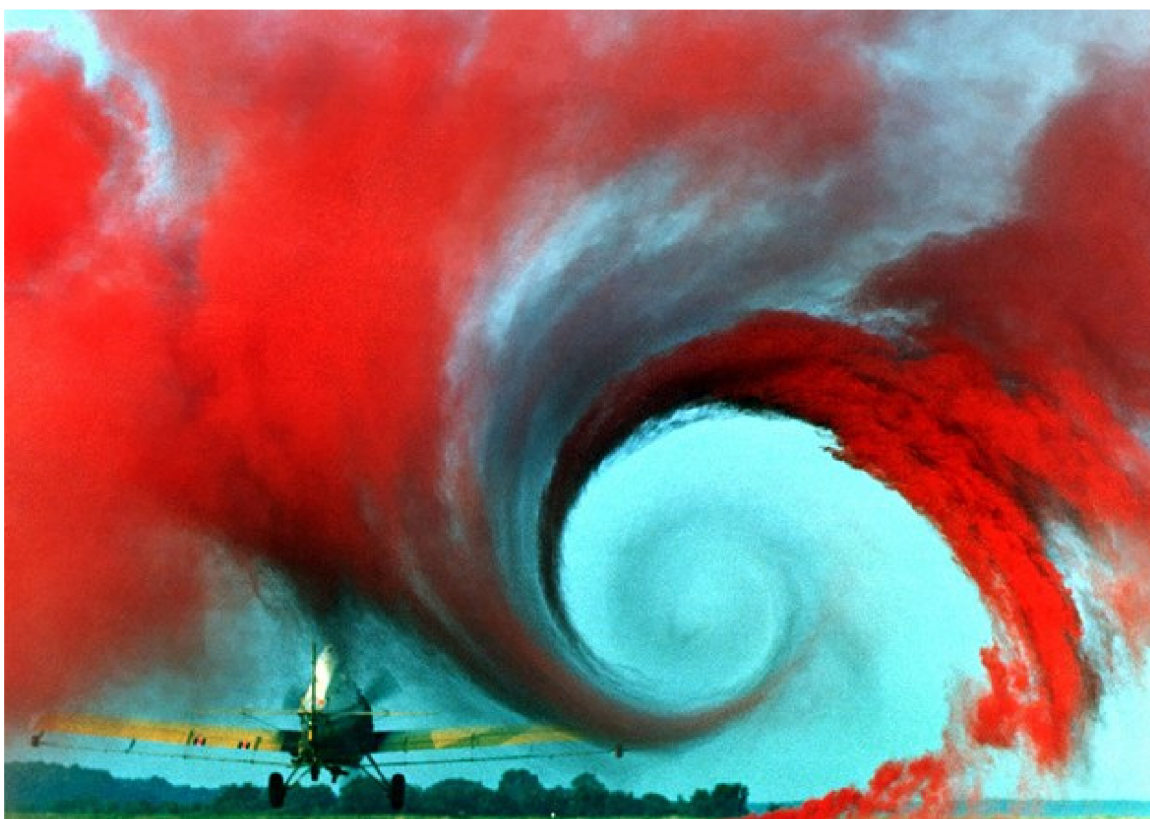
Obr.1: Turbulence v íplavu za letounem. Experiment provedla NASA
