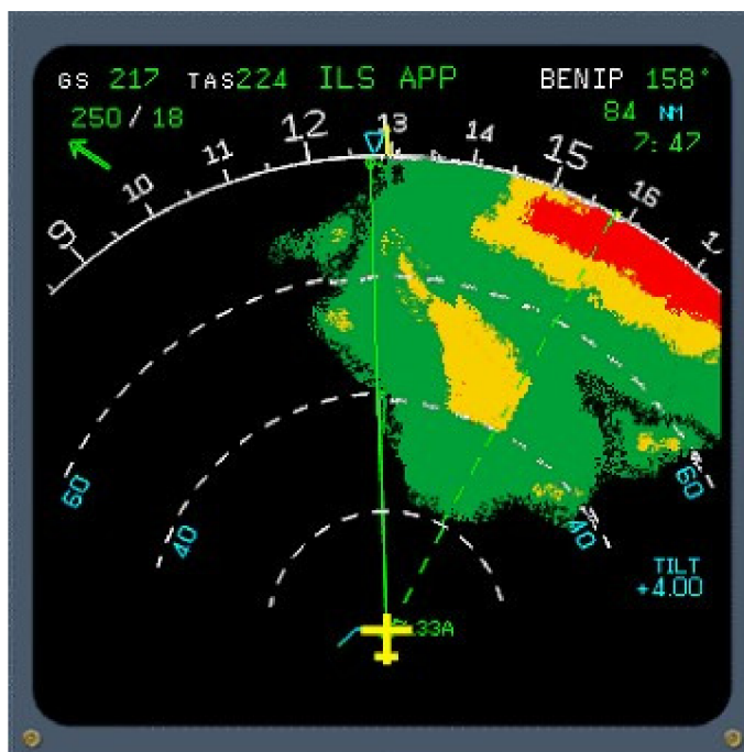
Obr. 16: Ukázka displaye z palubního meteorologického radaru
