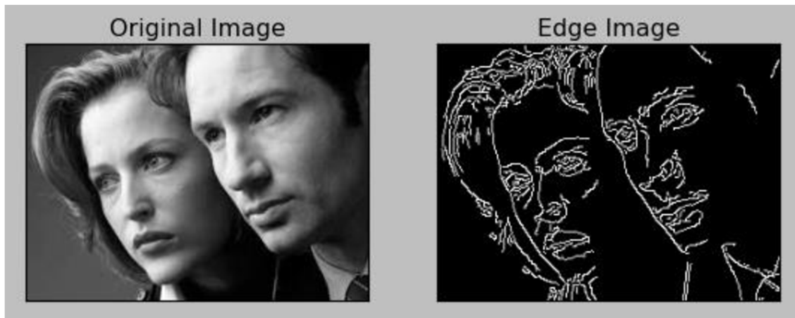
Obrázek 20: Cannyho hranový detektor [18]
