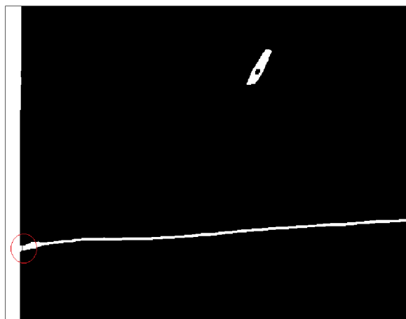
Obrázek 41: Oddělení defektu od okrajů (výřez ze snímku zachycující 1px oddělení od okraje, zakroužkováno červeně)
