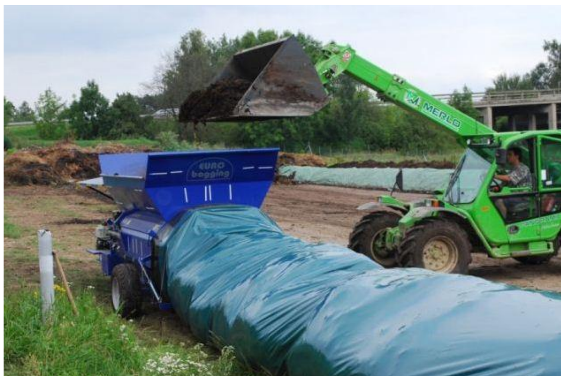
Obrázek 4 - Vkládání surovin do kompostovacího lisu
