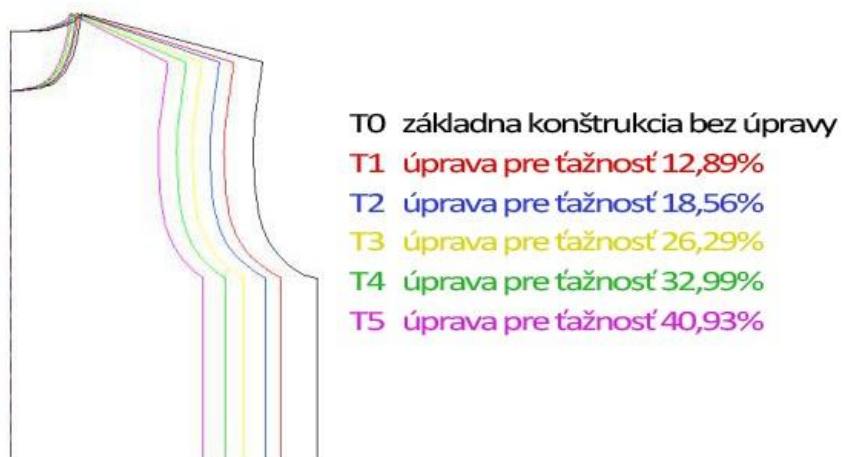
Obr. 18: Varianty tvarového riešenia strihu trička so zápornými prídavkami ku konštrukčným úsečkám [32]
