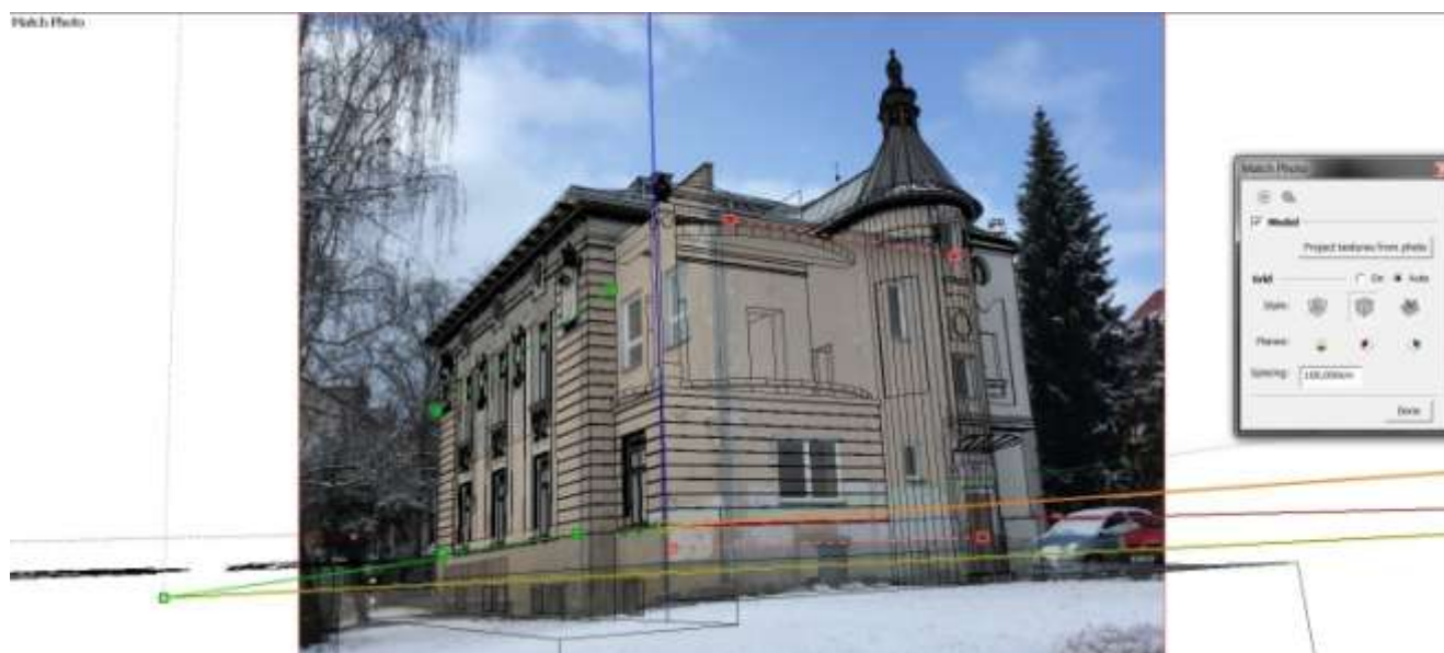
Fotogrammetrické odvozování tvaru a velikosti střechy nad schodištěm přes známý referenční bod.
