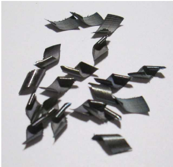
Třísky od nástroje bez povlaku (A)
