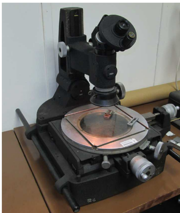
Obrázek 5.13 Mikroskop BM 1 V C 332 pro měření opotřebení VB
