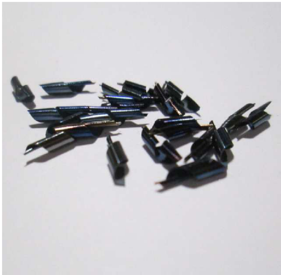
Třísky od nástroje s povlakem AlTiN (C)
