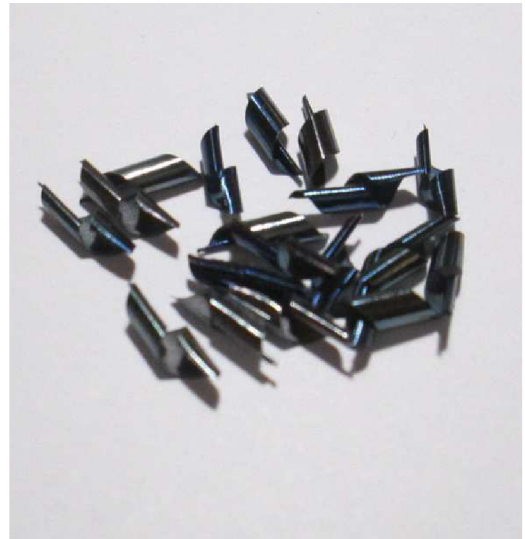
Třísky od nástroje s povlakem nACo® (B)
