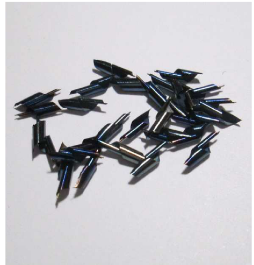
Třísky od nástroje s povlakem AlTCrN (D)
