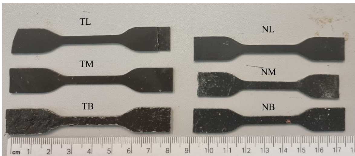
Obr. 32: Fotografie dog-bonů jednotlivých várek tvaru 5A vyražených z placek z tavenin
