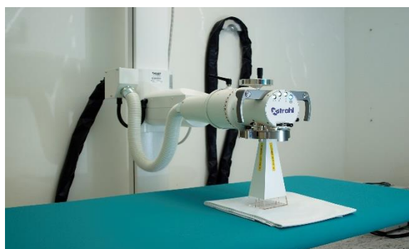
Obrázek 3 Tubusy terapeutického RTG ozařovače, zdroj: Berkovský
