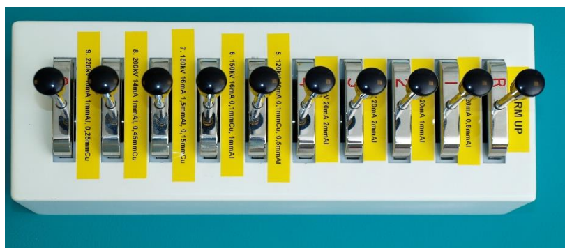
Obrázek 4 Filtry terapeutického RTG ozařovače, zdroj: Berkovský
