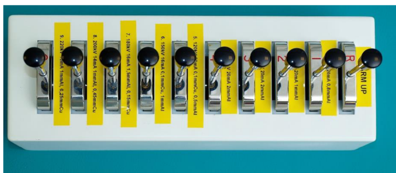
Obrázek 4 Filtry terapeutického RTG ozařovače, zdroj: Berkovský
