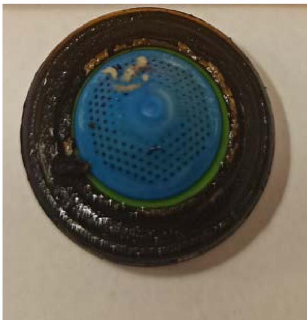
Foto. 4 – perlátor z m. č. 414, minerální usazeniny dané ohřevem vody a slizu.
