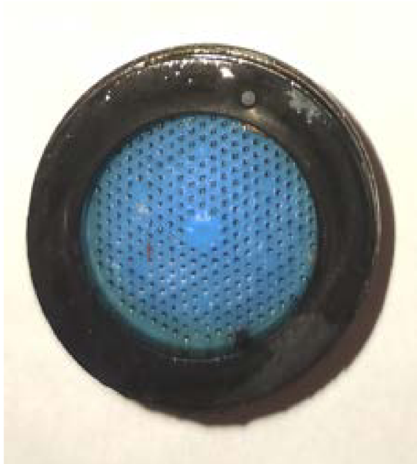
Foto. 3 – perlátor z m. č. 404, usazeniny nejsou zřetelné.
