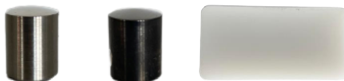
Obr. 4-3 Nepovlakovaný pin (vlevo), pin s DLC povlakem (uprostřed), UHMWPE destička (vpravo)
