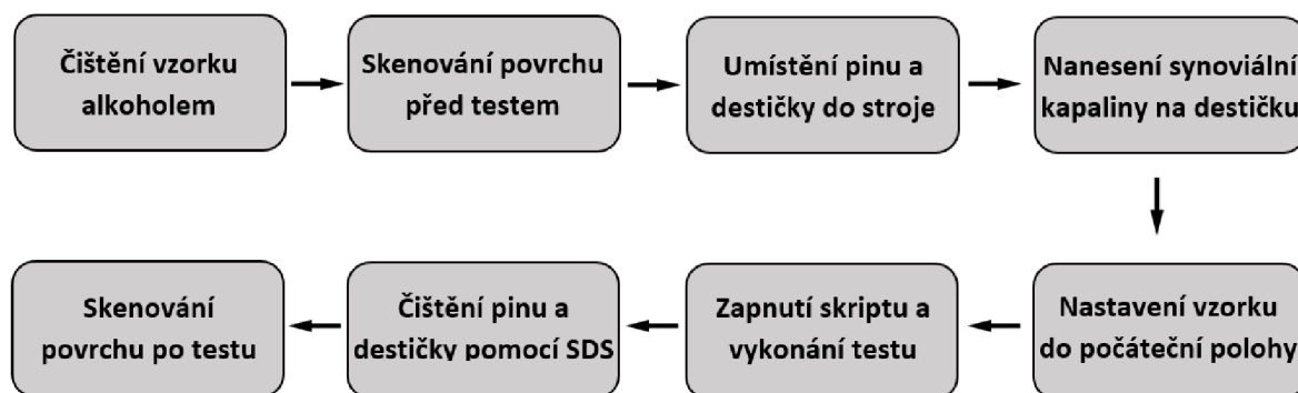
Obr. 4-5 Schéma postupu měření
