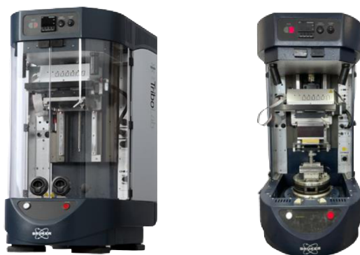
Obr. 4-1 Tribometr Bruker UMT TriboLab (převzato z [30])
