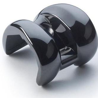
Obr. 2-6 DLC povlak na kloubní náhradě (převzato z [20])
