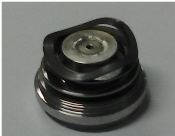
Obr. 8 Pružiny na dolním pouzdře
