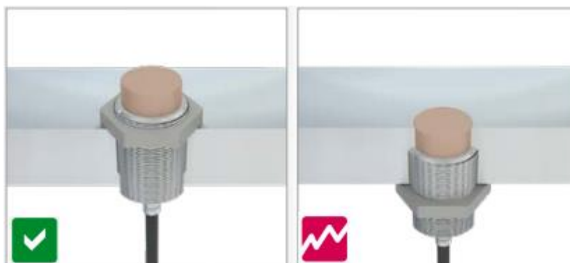
Obr. 21 Zástavba nevazebního snímače na principu vířivých proudů [48]
