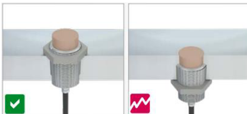
Obr. 21 Zástavba nevazebního snímače na principu vířivých proudů [48]
