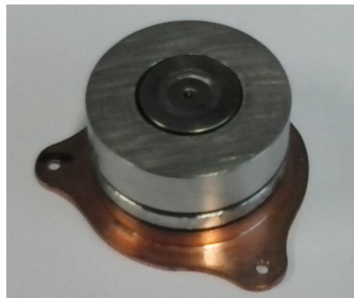
Obr.9 Zakrytované průžiny (+ základová deska)
