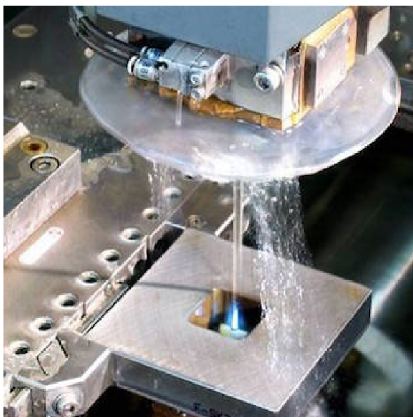
Obr. 1. Technologie elektroerozivního drátového řezání [7].
