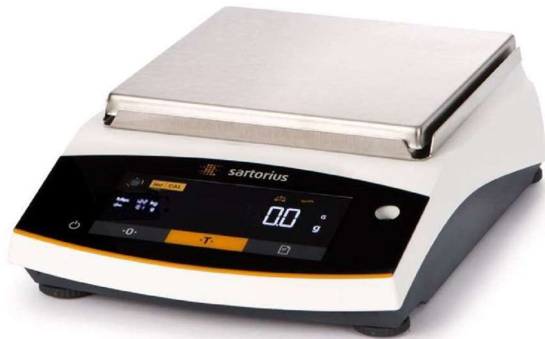
Obr. 2-12 Příklad stolní klenotnické váhy bez krytu [12]
