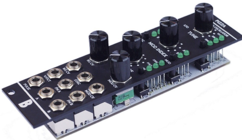
Obr. 2. 22: Výsledný smontovaný modul navrženého digitálního napětím řízeného oscilátoru
