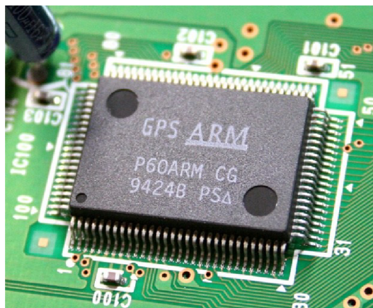
Obr. 1. 28: Mikroprocesor architektury ARM [23]
