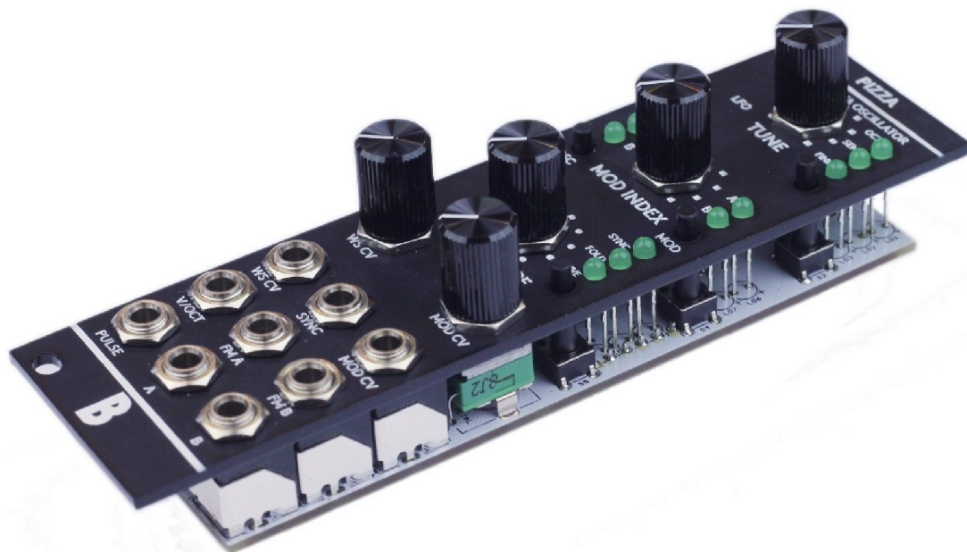
Obr. D. 1: Výsledný modul digitálního napětím řízeného oscilátoru
