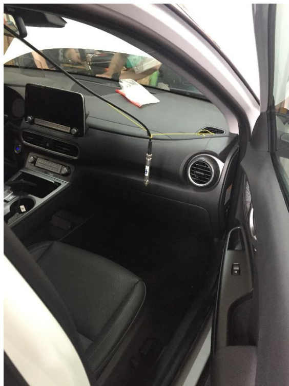
Obr. 65b Umístění mikrofonu v úrovni okna
