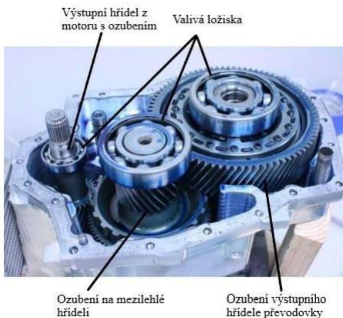
Obr. 33 Jednostupňová převodovka u BEV [9]
