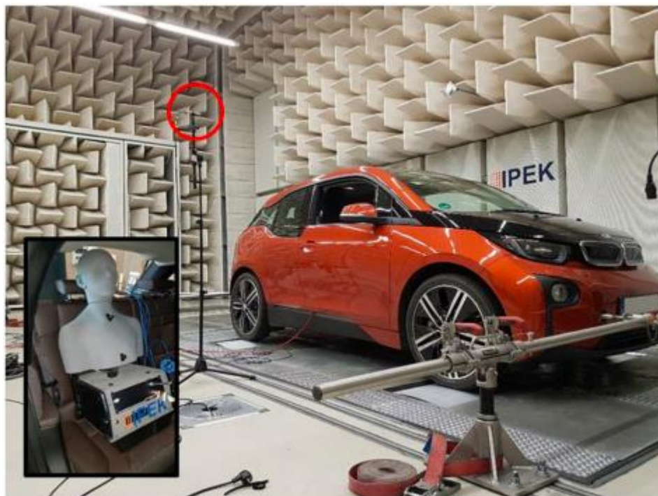
Obr. 20 Sestava pro měření v bezdovukové komoře [47]
