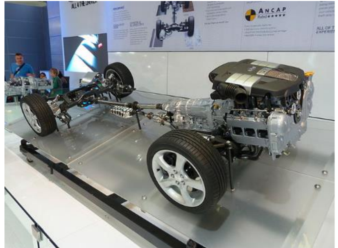
Obr. 26 Pohonný systém u spalovacího vozidla [22]
