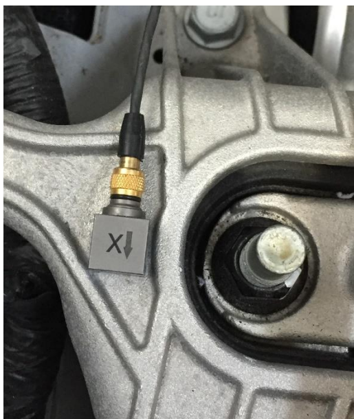
Obr. 66c Umístění akcelerometru T2
