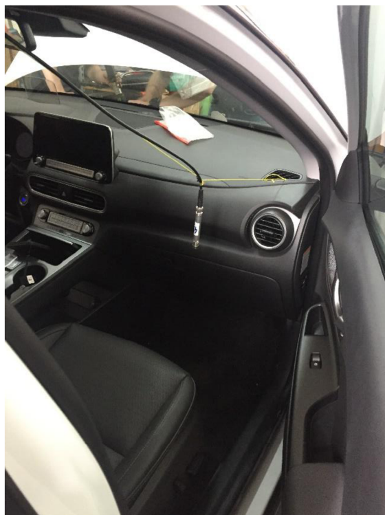
Obr. 65b Umístění mikrofonu v úrovni okna
