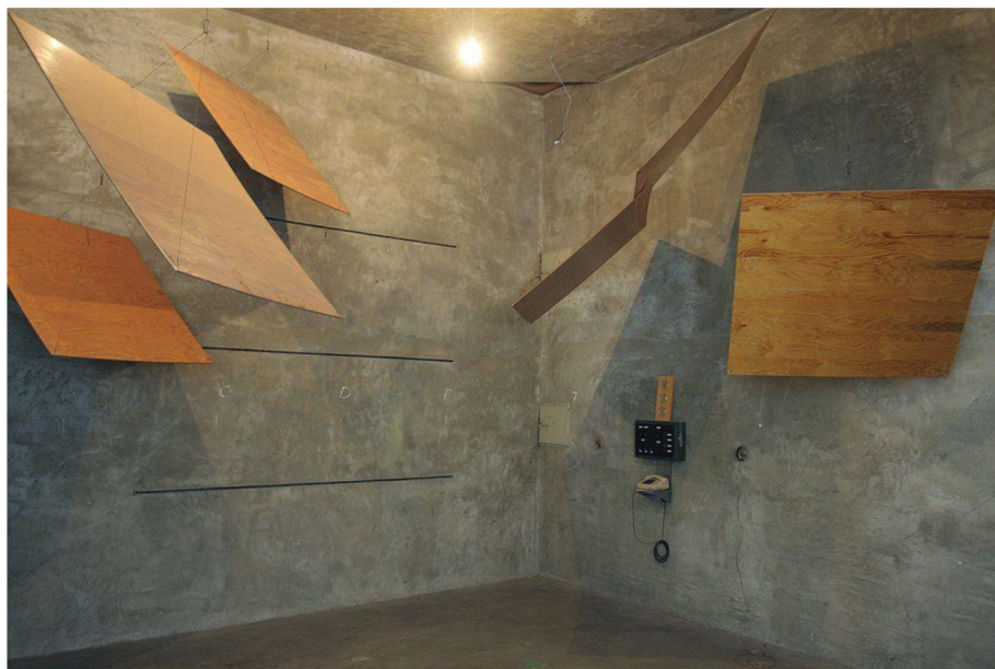
Obr. 18 Dozvuková komora v Drážďanech [43]
