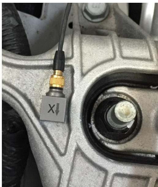
Obr. 66c Umístění akcelerometru T2
