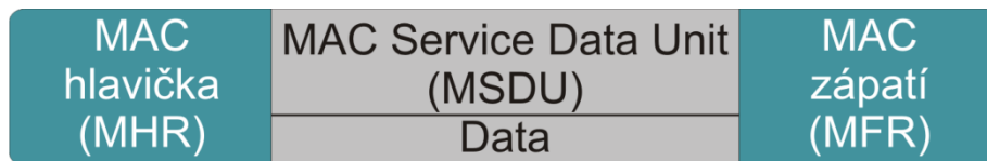
Obr. 15 Struktura rámce MAC vrstvy
