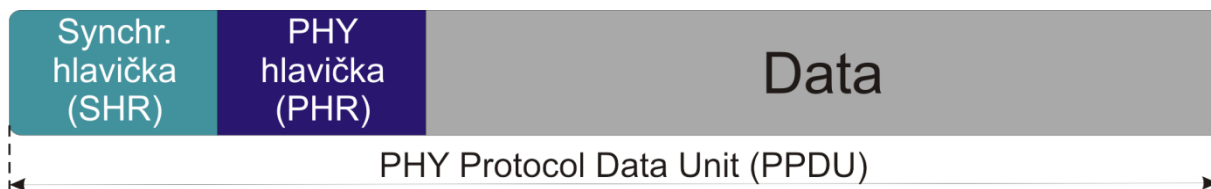
Obr. 8 Struktura datové jednotky fyzické vrstvy
