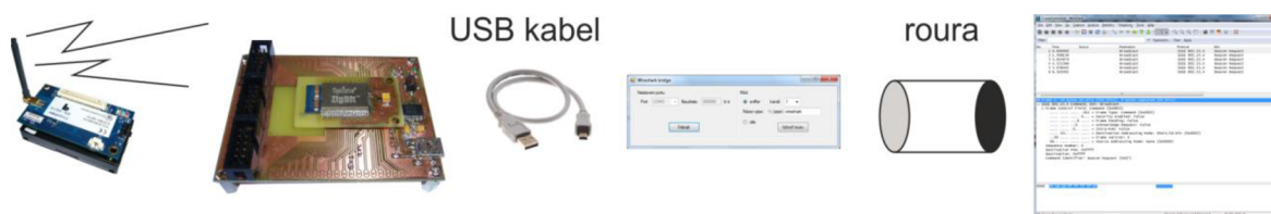
Obr. 33 Princip komunikační cesty od uzlu do Wiresharku
