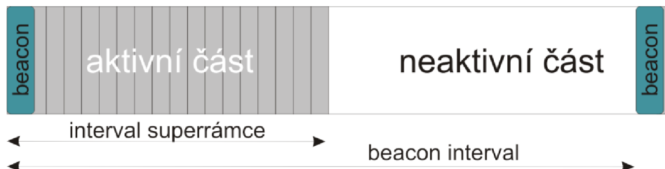
Obr. 14 Struktura superrámce s aktivní a neaktivní částí
