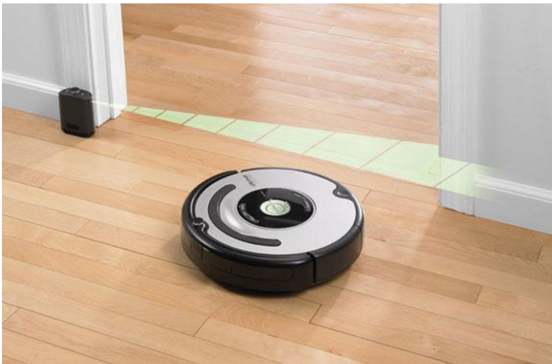
Obr. 5 Vysavač Roomba využívající technologii virtuálních zdí [15]
