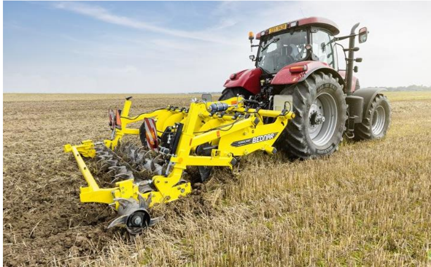
Obr. 2: Hlubkový kypřič Bednar FMT Terraland (Bednar farm machinery, 2016)
