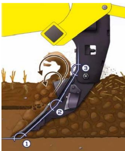
Obr. 1: Schéma slupice hlubkového kypřiče (Bednar farm machinery, 2016)
