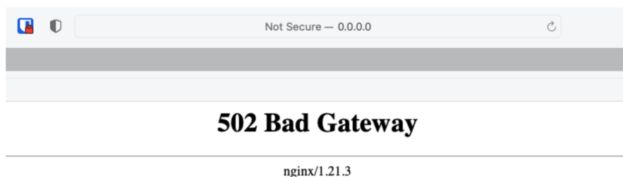
Obrázek 12: Chybová hláška NGINX serveru při přesměrování na neexistující server
