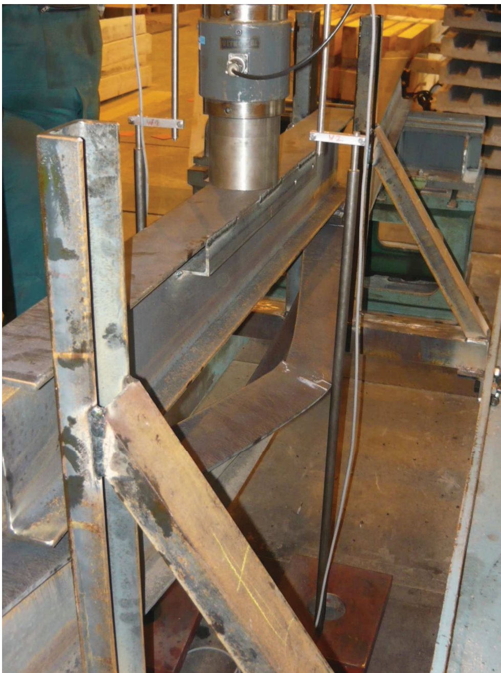
Obr. 13.4 Zkušební nosník po překročení únosnosti s přetažením zatěžování. V této fázi již docházelo k trhání horní pásnice.
