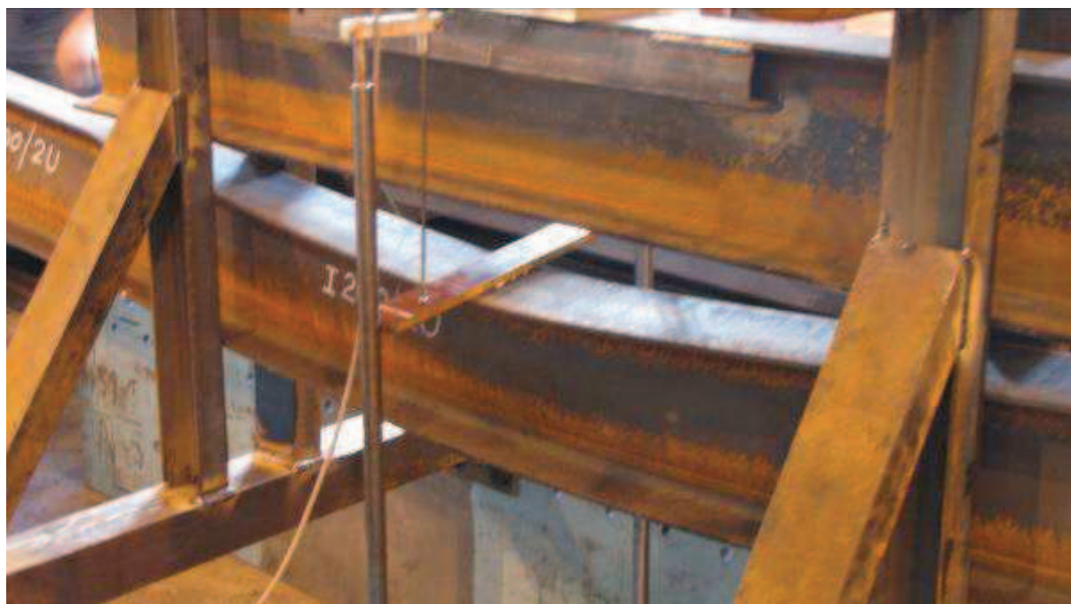
Obr. 10.8 Průhyboměr v konečné poloze v závěru zatěžování
