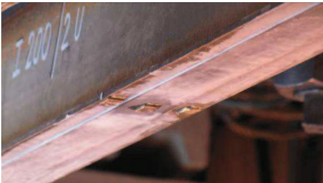
Obr. 10.10 Nalepené tenzometry na spodní pásnici na začátku zatěžování
