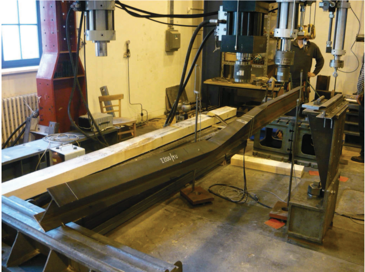
Obr. 13.6 Ukázka nosníku u kterého nebyla instalována konstrukce bránící klopení. Ve srovnání s předchozími obrázky je patrné, že k vybočení došlo mnohem dříve než bylo dosaženo zplastizování.
