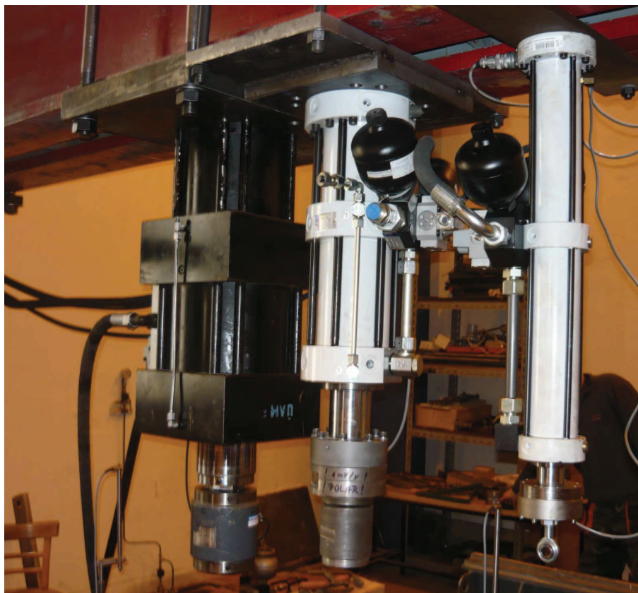
Obr. 10.5 První zleva je vyobrazen použitý přímočarý hydromotor AG 100-100, INOVA Praha
