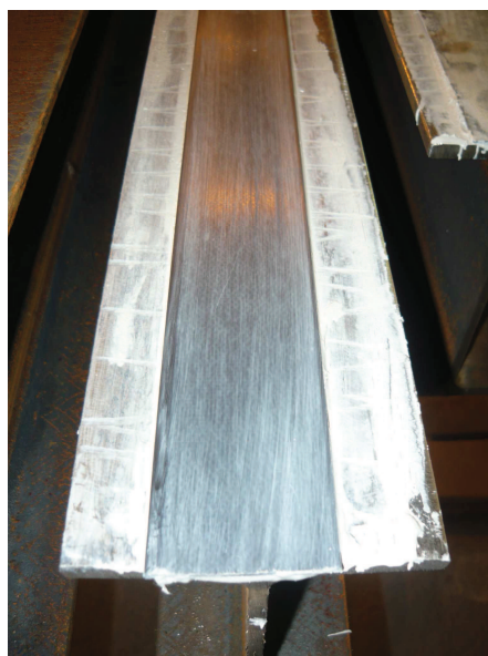
Obr. 7.1 Uhlíková lamela po nalepení a vytvrzení lepicí hmoty
