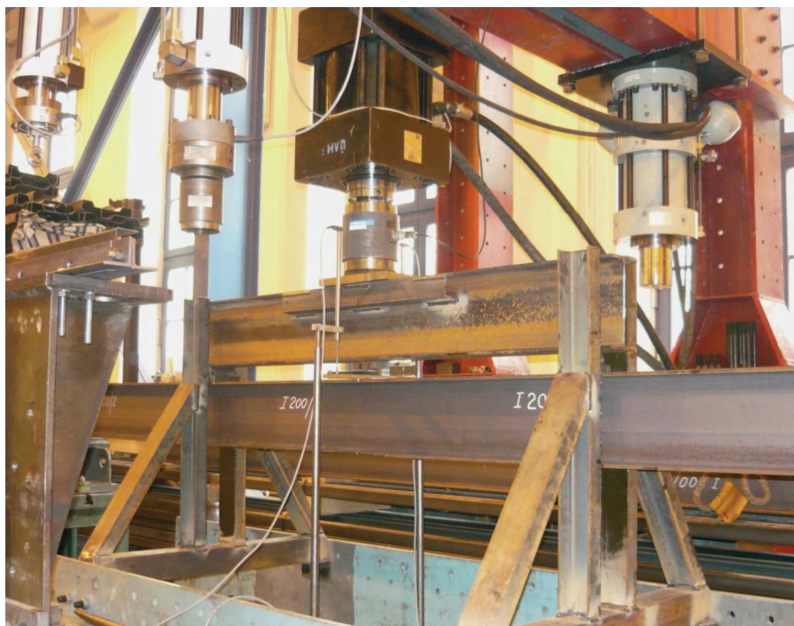
Obr. 6.1 Experimentální ověření – zatěžování ocelového nosníku s nalepenou uhlíkovou lamelou na spodní pásnici
