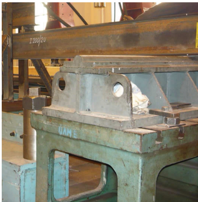
Obr. 10.2 Úložný blok s experimentálně ověřovaným nosníkem
