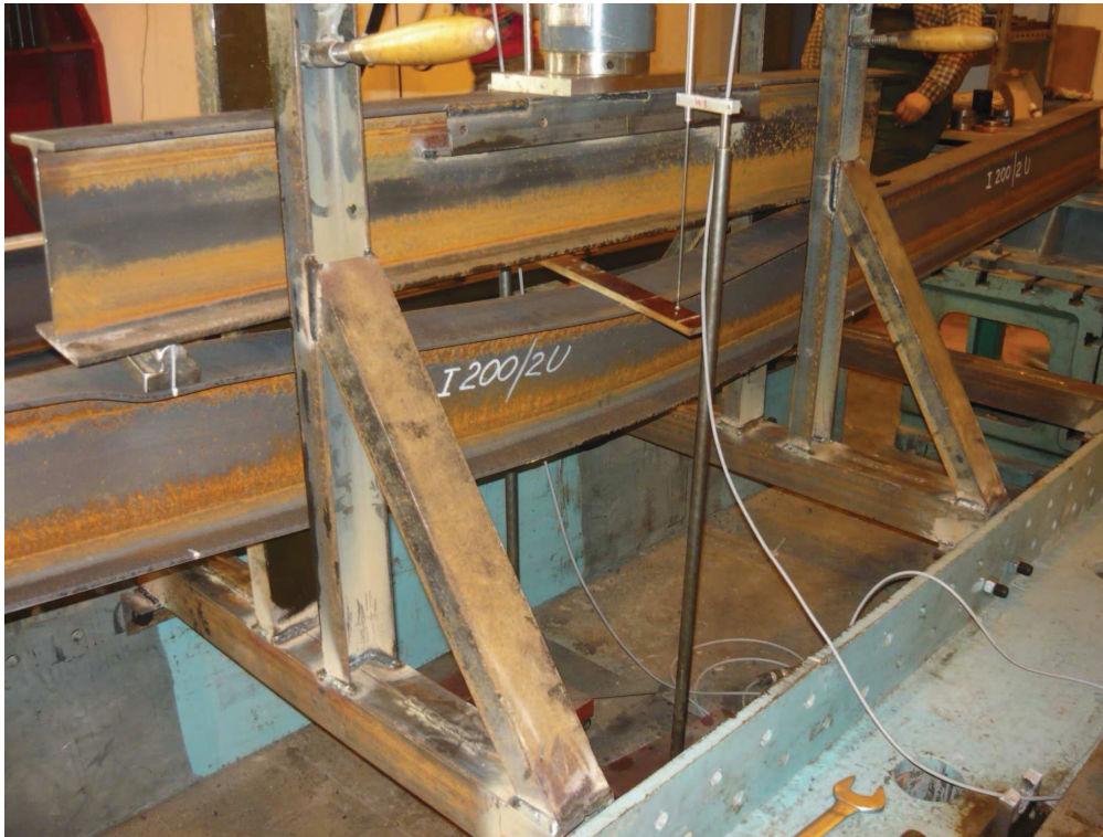
Obr. 13.1 Zatěžovací sestava se zesíleným nosníkem po překročení únosnosti. Z obrázku je patné příčné vybočení horní pásnice nosníku.
