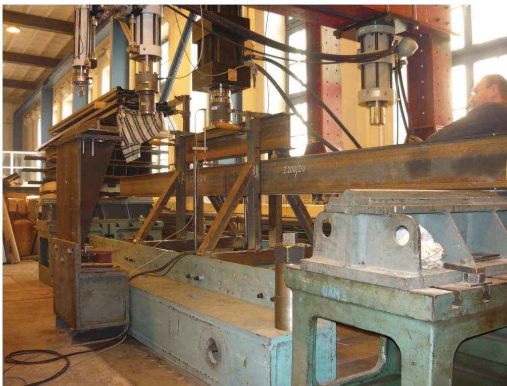
Obr. 13.7 Zatěžovací sestava s připraveným zkušebním nosníkem před zahájením zatěžování
