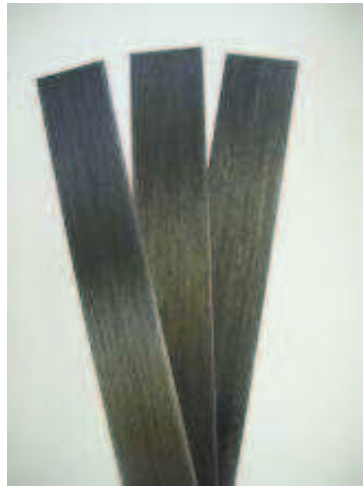
Obr. 4.7 Lamely z uhlíkových vláken s matricí z polymerní epoxidové pryskyřice [10]
