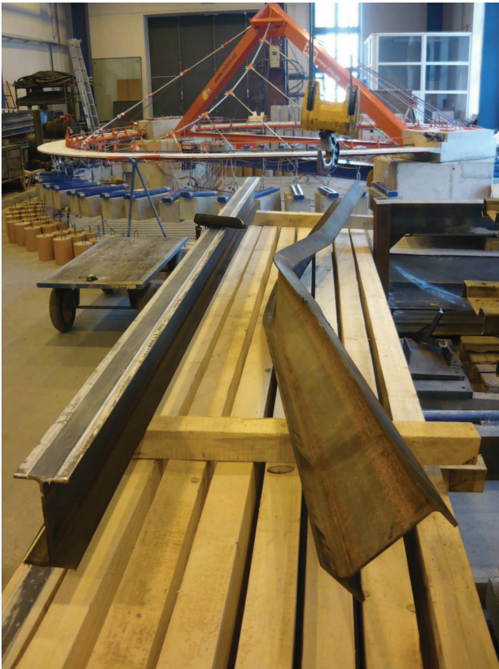
Obr. 13.5 Na obrázku je zobrazen připravený nosník s nalepenou uhlíkovou lamelou a zničený nosník. Zničení bylo způsobeno závadou na ovládacím zařízení, kdy se nepodařilo včas zastavit pohyb hydromotoru.
