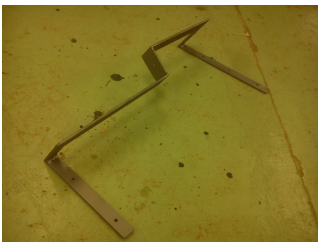
Obrázek 31: Kovový dílec pro zpevnění podnožky (foto autorka)
