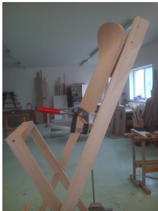
Obrázek 29: Zkoušení rozměrů lišty pro upevnění sedáku a jeho zvedání (foto autorka)
