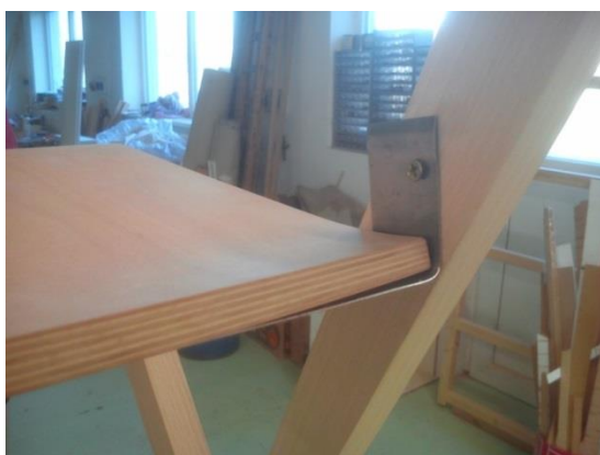
Obrázek 28: Dočasné připevnění zkušební lišty pro spojení se sedákem (foto autorka)
