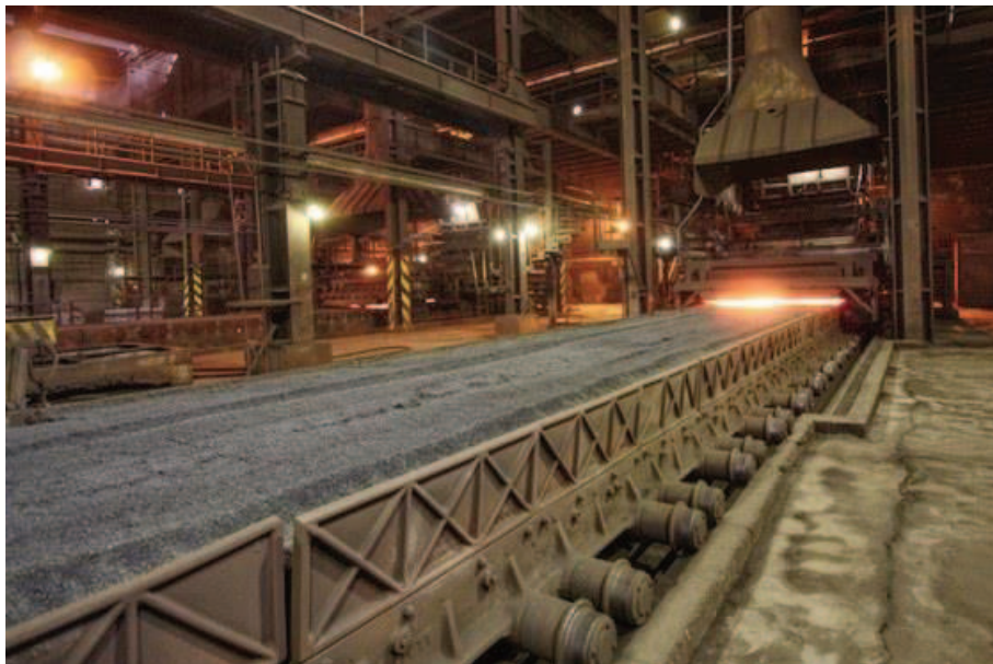
Obrázek 3 - Nekonečný pás, na kterém se spéká prachová ruda
