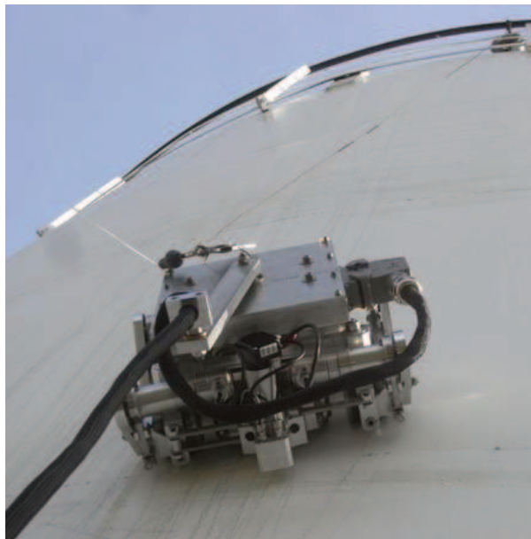
Obrázek 21 - Kontrola povrchu nádrže dálkově ovládaným robotickým vozíkem
