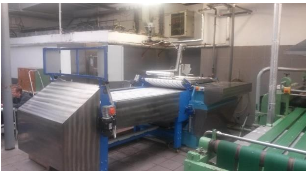
Obrázek 11: Valchovací stroj pro pokročilou technologii valchování (TONAK)
