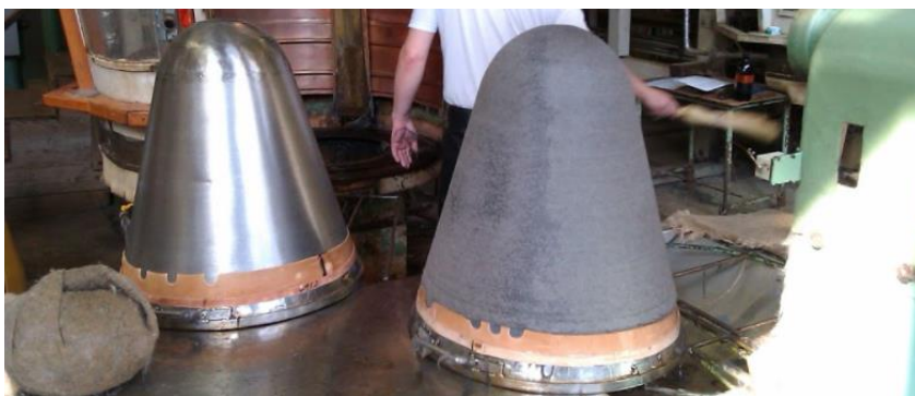
Obrázek 10: Plástěcí forma neboli zvon. Vlevo prázdná, vpravo s plstěncem. (Louda, 2007)
