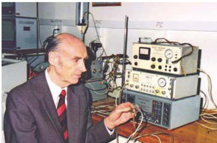
Obr. 2.3: Snímek prof. MUDr. Jana Peňáze, CSc. při demonstraci měření krevního tlaku pomocí fotopletysmografické metody. [28]
