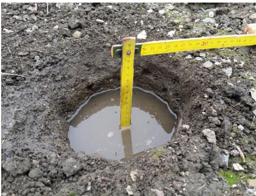
Foto. č. 6: Probíhající měření hydraulické vodivosti svrchní půdní vrstvy pomocí metody plněné sondy (autor práce, 2017)
