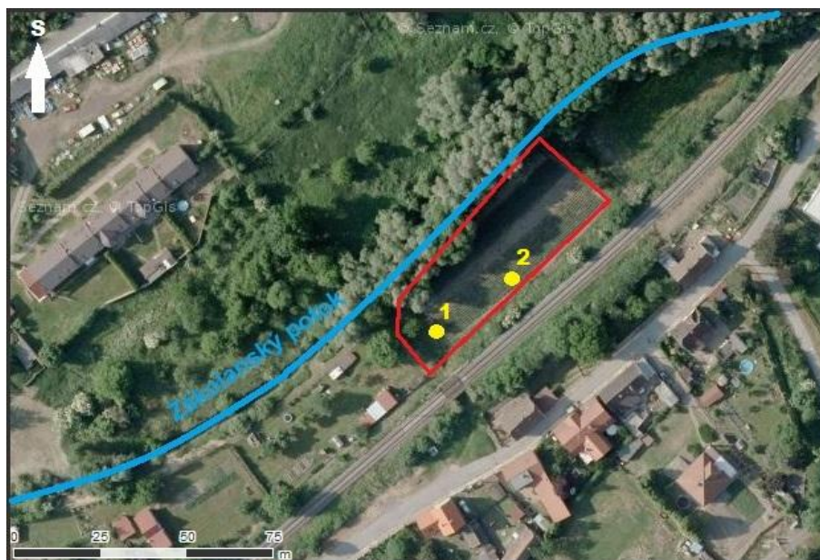
Obr. č. 14: Letecký snímek části obce Otovice s červeně ohraničenou zájmovou lokalitou a žlutě vyznačenými místy měření hydraulické vodivosti K [L \cdot T^{-1}] metodou plněné sondy (Mapy.cz, 2017a)
