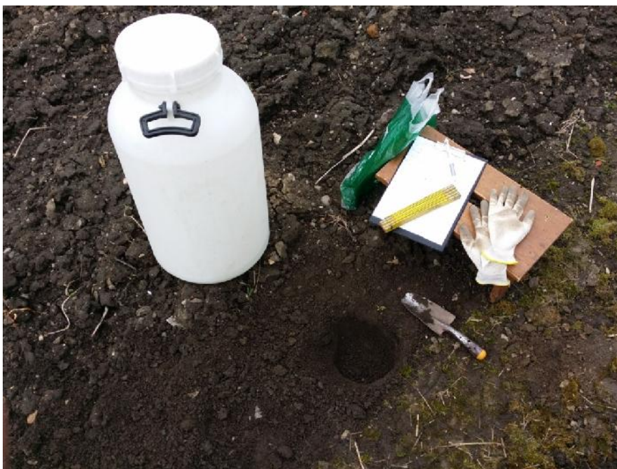
Foto. č. 5: Příprava na měření hydraulické vodivosti svrchní půdní vrstvy pomocí metody plněné sondy (autor práce, 2017)
