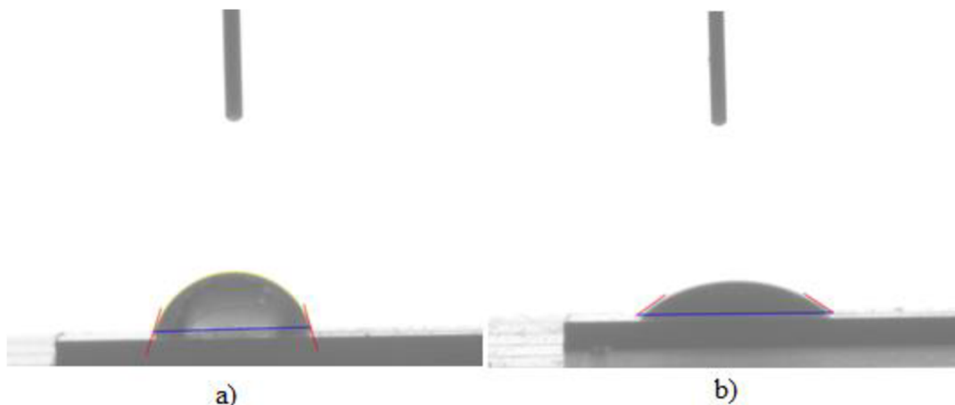
Obr. 33 Meraný kontaktný uhol a) nemodifikovanej a b) v plazme modifikovanej tlačenej uhlíkovej elektródy
