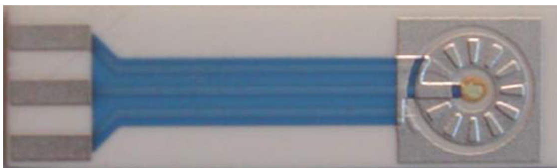
Obr. 5 Elektrochemický senzor použitý pri úprave [19]
