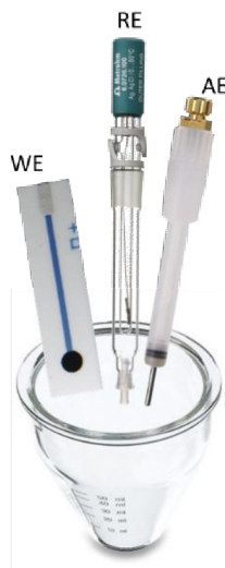
Obr. 23 Trojelektrodové usporiadanie použité pri meraní
