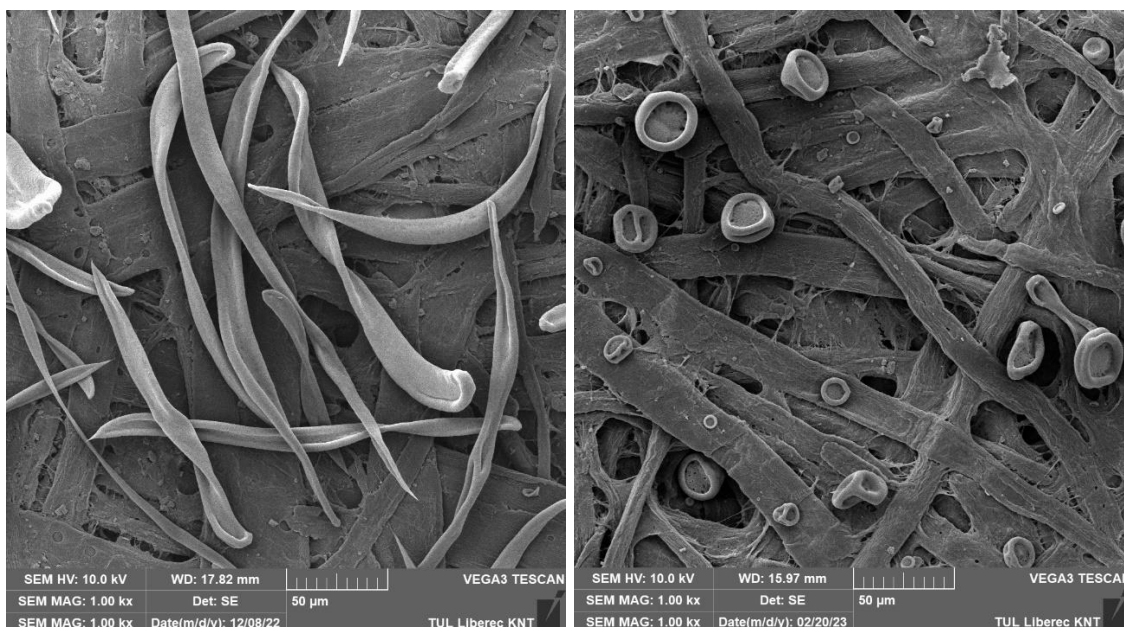
Obr. č. 12 a 13: příklady naprašování – vlevo náznak vláken z experimentu č. 1, vpravo mikročástice z experimentu č. 5 (zvětšení 1000x)
