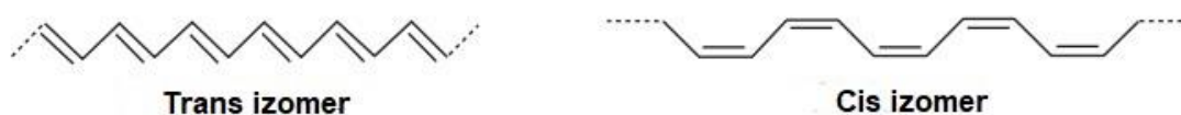
Obr. č. 5: Struktura konjugovaného řetězce polyacetyleny a jeho dva základní izomery (Anon, 2006).
