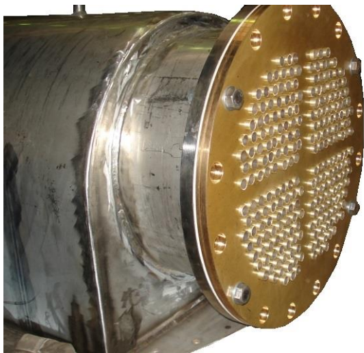
a) sestavení kondenzátoru
