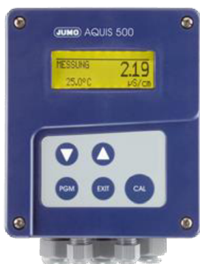
Obr. 38 Sofistikovaný přístroj k měření vodivosti (Jumo) [81]
