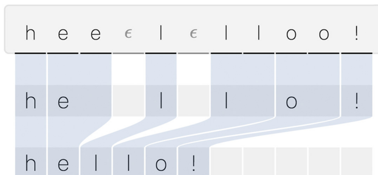
Obrázek 2.6: Princip CTC dekodéru.
