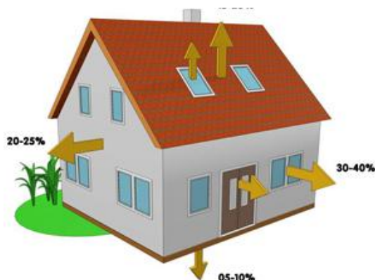
Obr. 11 Podíl tepelných ztrát u rodinného domu
