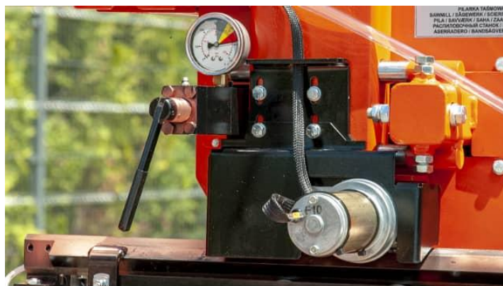
Obrázek 17 Systém napínání pilového pásu
