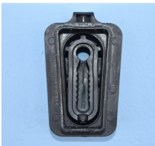
Obr. 27 Izolátor umožňující posun Citroen DS4 2022 [13]
