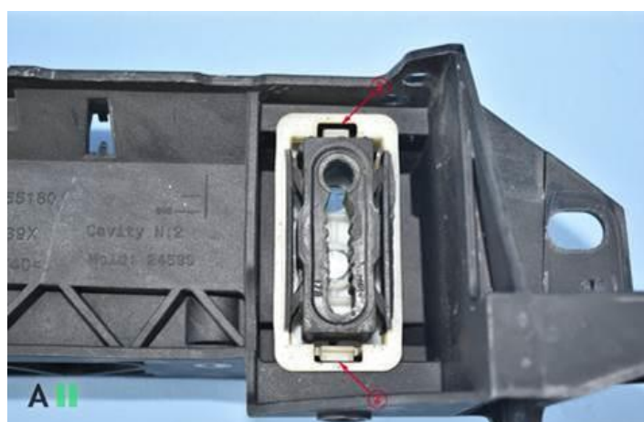
Obr. 28 Izolátor umožňující posun zasazený v rámu Citroen DS4 2022 [13]
