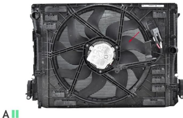
Obr. 22 Ventilátor s krytem BMW iX xDrive50 Sport 2022 [13]
