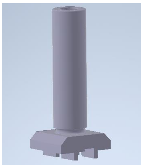
Obr. 23 Odlamovací pin z 3D modelovacího softwaru (projekt Volvo) [13]
