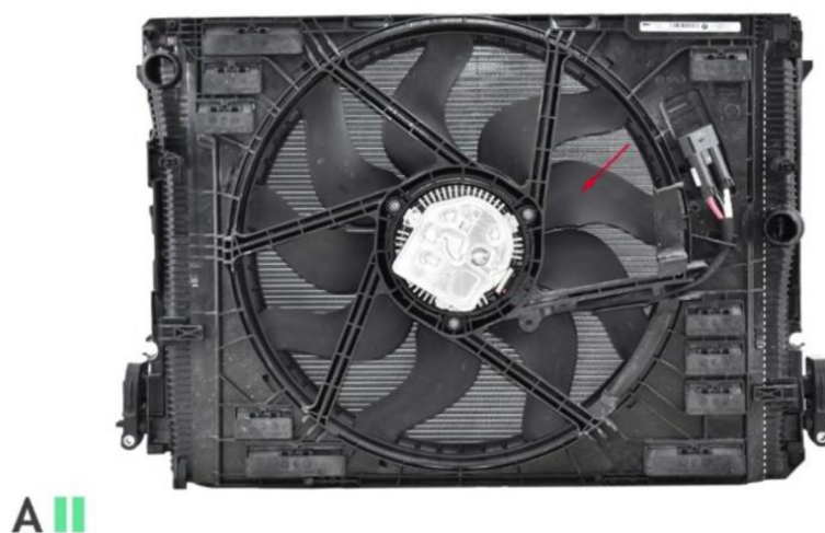
Obr. 22 Ventilátor s krytem BMW iX xDrive50 Sport 2022 [13]
