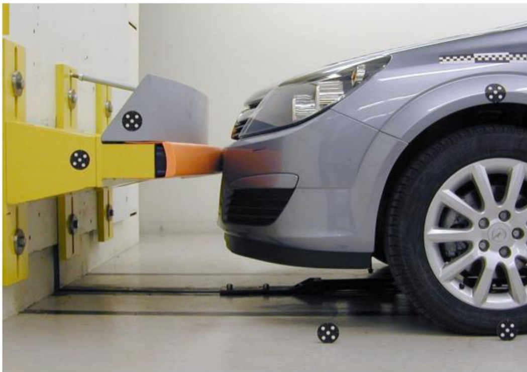
Obr. 8 Pohled na vozidlo při nárazu do deformovatelné bariéry
