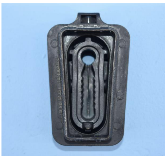
Obr. 27 Izolátor umožňující posun Citroen DS4 2022 [13]
