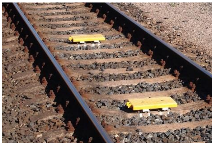
Obr. 6: Podoba evropského zabezpečovacího systému na kolejích Zdroj: SŽDC (2018)
