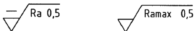
a) Značení dle ČSN EN ISO 21920-1 b) Značení dle ČSN EN ISO 1302
