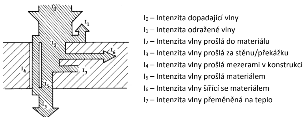
Obrázek 4 šíření vlny po dopadu na překážku (Nový 2009)
