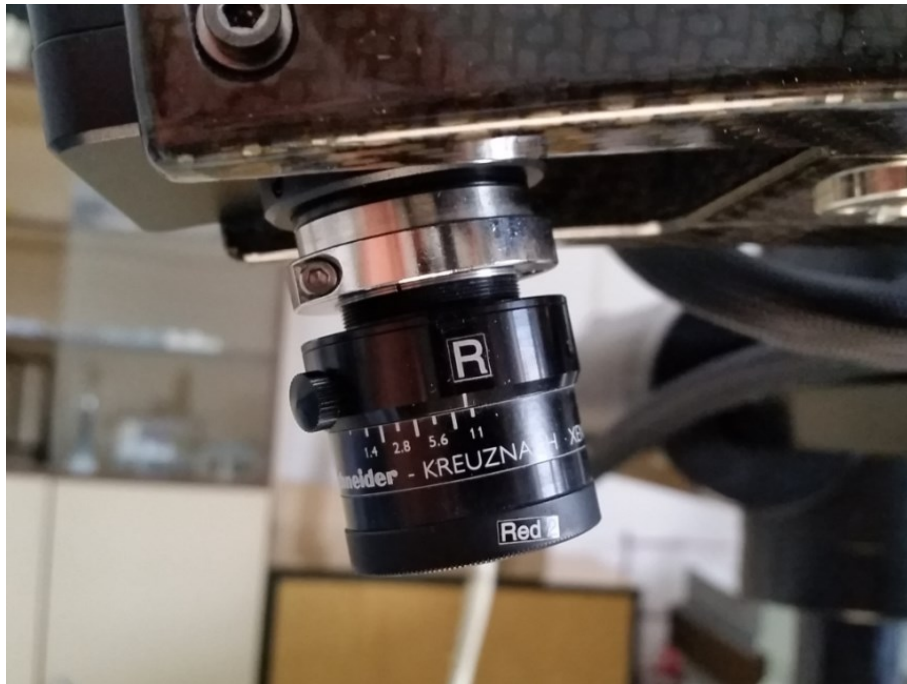
Příloha 4: Clona kamery – detail na nastavitelnou stupnici
