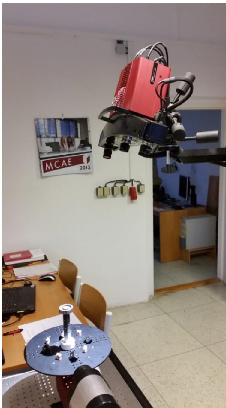
Příloha 3: Úhel náklonu skeneru 75°
