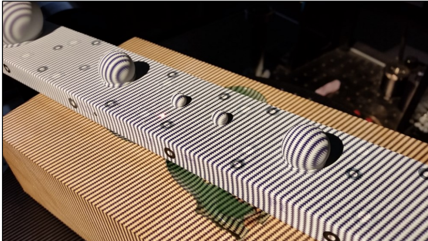
Obrázek 13: Měřený etalon – promítnutý rastr na povrchu
