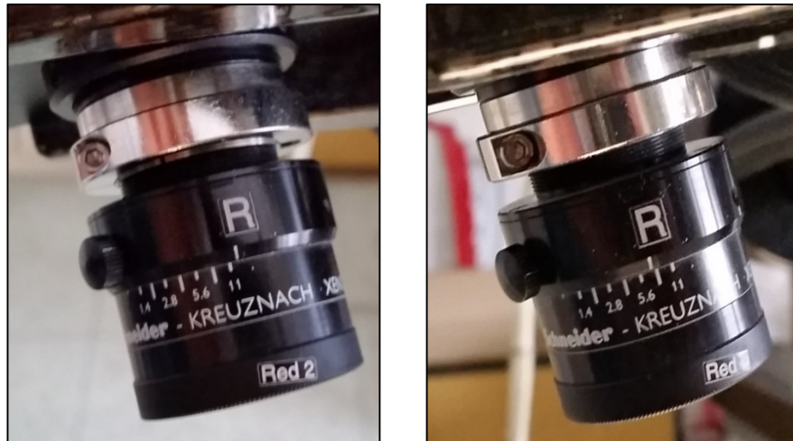
Obrázek 34: Změna clony – EV 8 (vpravo) EV 11+ (vlevo)
