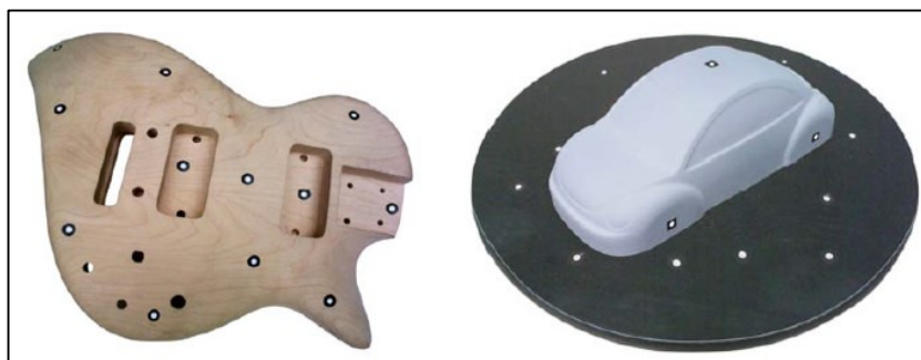
Obrázek 17: Příklad doporučeného umístění referenčních značek [12]
